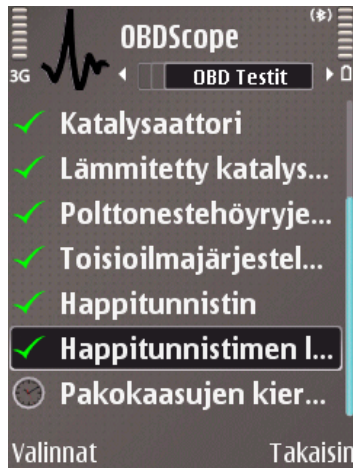
Kuva 12: OBD-testien eli valmiustestien tila on osa OBDScopeen tekemää diagnoosia. Suoritetut testit ilmaistaan vihreällä väkäsellä, suorittamaton testi kellon kuvalla.
