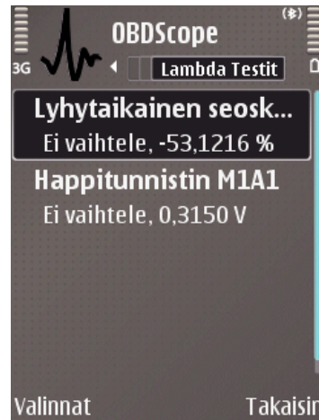
Kuva 13: Lambda-testeillä analysoidaan polttoaineen seossuhteen säädön, eli lambdasäädön toimintaa.
